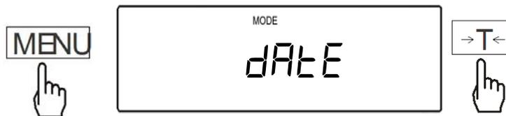
2. The scale will display options “Dat On, Dat Off, Dat Set, Dat Pin, Dat For” . To enable Date stamping press the T key when “Dat On” is displayed, to disable press the T key when “Dat Off” is displayed.
